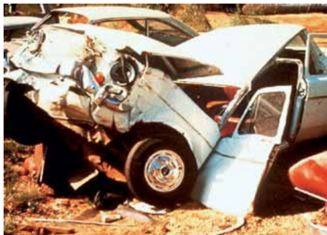
FIGURA 2.3 El vehículo se detiene súbitamente contra un muro de contención.
