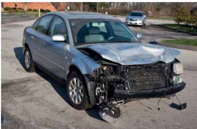
FIGURA 2.11 Cuando un vehículo se impacta contra un poste de luz, el frente del carro se detiene pero la porción trasera del vehículo continúa su viaje hacia delante, lo que produce la deformación del vehículo.
